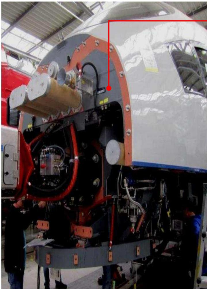
Применение модульных систем пассивной безопасности – крэш модули
